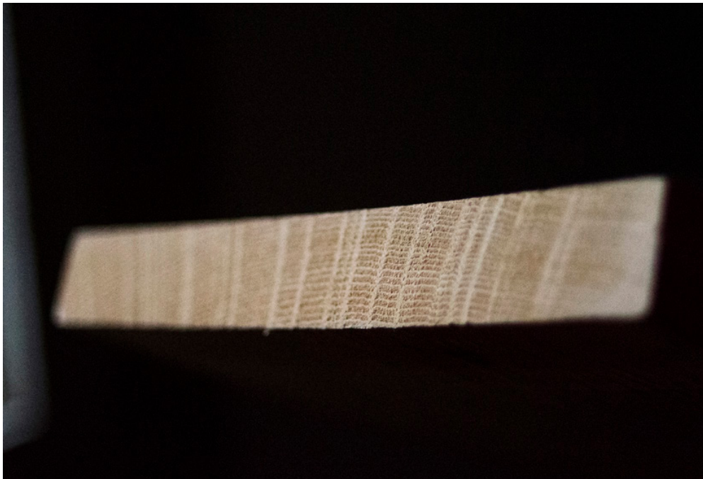
Figura 8. Sezione di tavola di abete rosso nella quale è possibile notare la compattezza delle fibre
