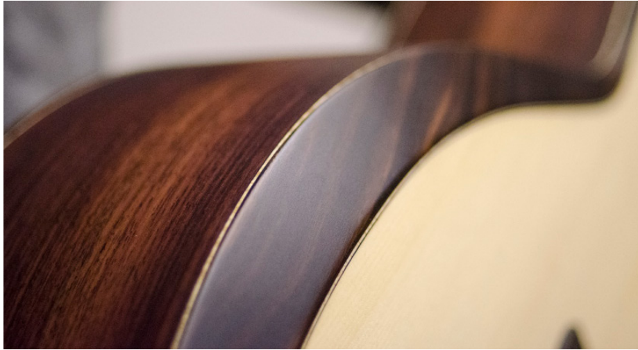
Figura 11. Scanso ergonomico intersiato delle chitarre acustiche Thomas Guitars
