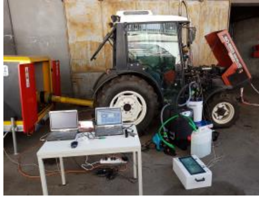
Figura 3 – Prova di differenti miscele di combustibili su trattori agricoli (freno dinamometrico a sinistra, misuratore di consumi a destra davanti al trattore, saggiaatore di gas di scarico dietro al trattore, datalogger e sistema di controllo in primo piano).
